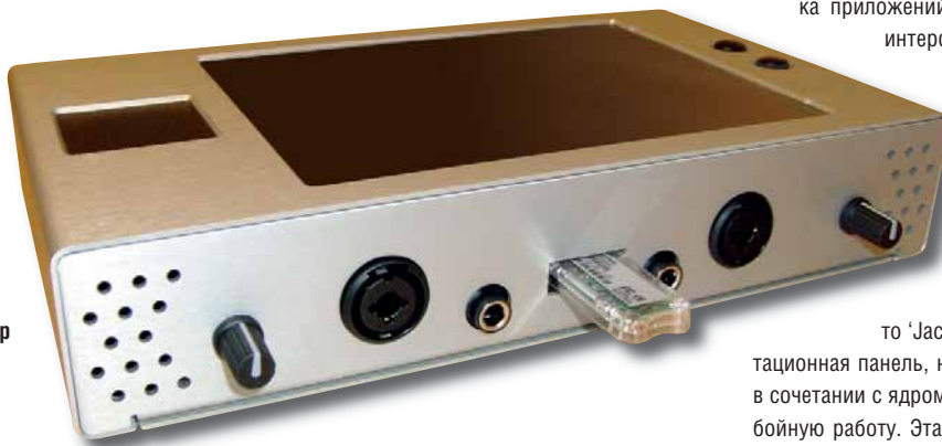
» Задняя панель Ontario (видны входы/выходы аудио и блок USB Wi-Fi).
