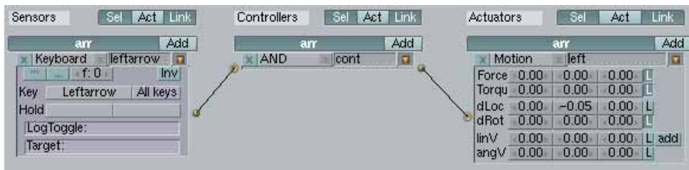
► Рис. 1. Логическая цепочка для стрелки.
